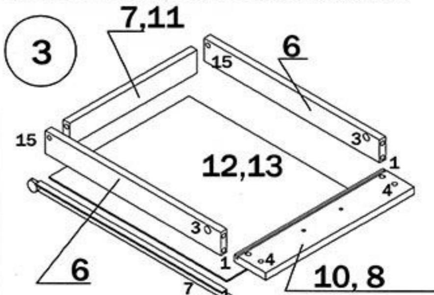
имеющейся на передних панелях 10, 8, вставить дно ящиков 12,13 до упора. Затем выровнять дно ящиков 12 и 13 по периметру с боковинами 6 и задними стенками ящиков 7, 11
