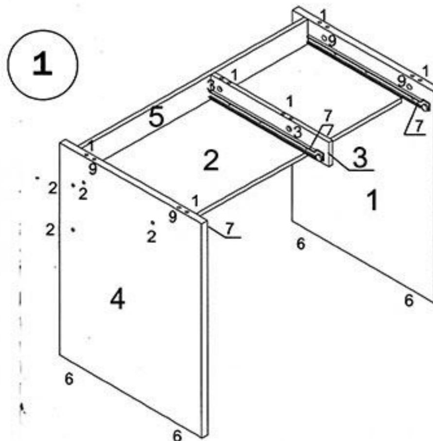
Соединить боковины 1 и 4 с деталями 2 и 5 при помощи шкантов (1) и евровинтов (2). Присоединить стойку 3 к полке 2 при помощи шкантов (1) и евровинтов (15).
