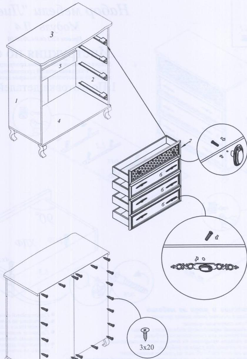
Опоры следует крепить по наколкам с внутренней стороны нижней стенки после сборки корпуса
