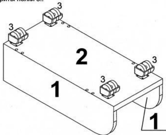
3. Перевернуть жележку установив ее на опоры колесные. При комплектации изделия опорами колесными с тормозом для свободного перемещения изделия необходимо снять опоры колесные с тормоза, путем нажатия на тормозную площадку расположенную на опоре колесной.
