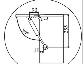
Во избежание выдавливания вязки тщательно соблюдайте порядок установки газового кронштейна
