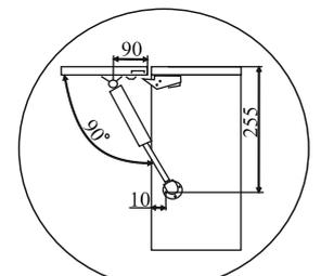
Во избежание выдавливания вязы тщательно соблюдайте порядок установки газового кронштейна
