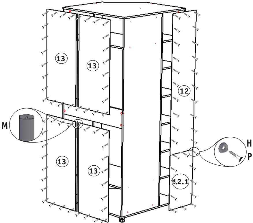
**Рис. 4. Установка задних стенок шкафа.**
