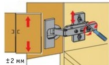
Двери можно точно выверить по высоте с помощью монтажных планок, регулируемых по высоте.
