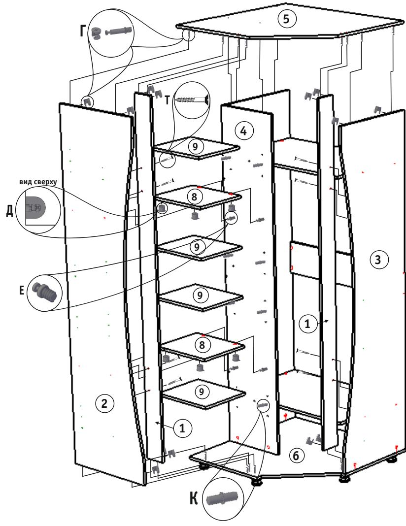
**Рис. 3. Сборка каркаса шкафа.**
