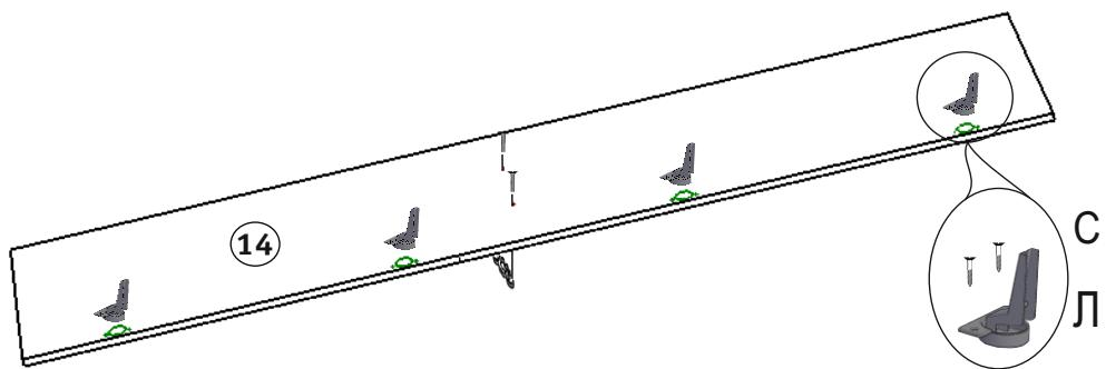
**Рис. 5. Установка петель на фасаде.**
