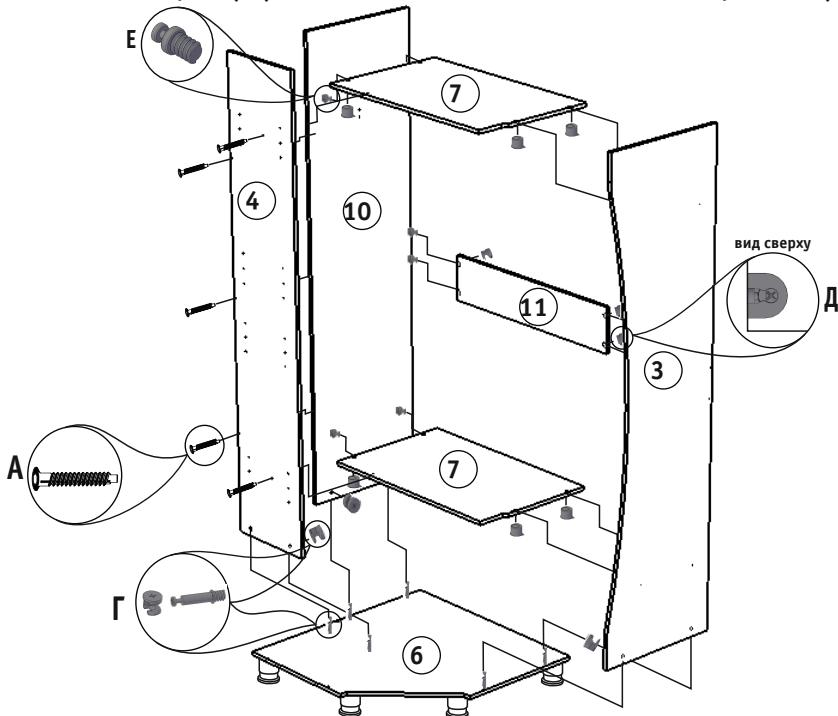
Рис. 2. Сборка каркаса.
