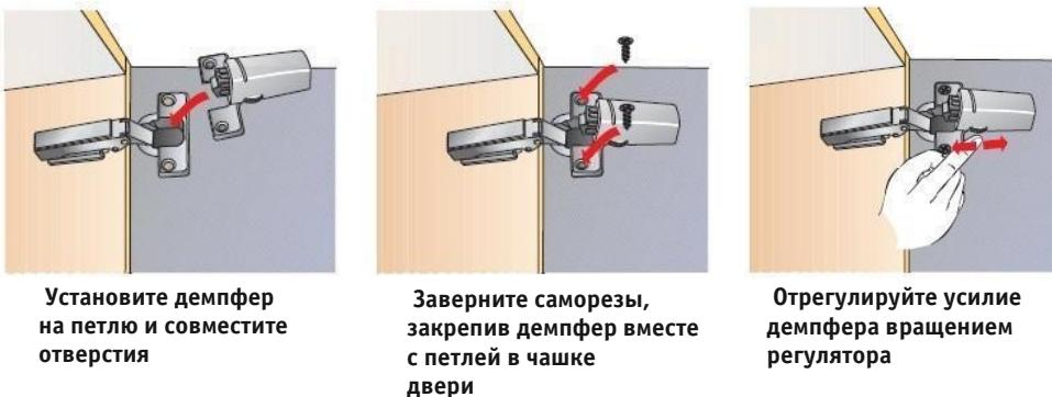
**Рис. 11.** Установка демпфера в чашку петли
