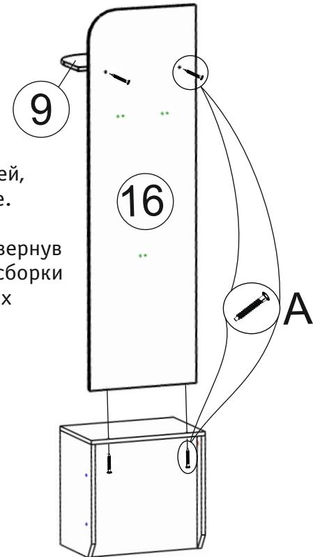
**Рис. 6.** Соберите вторую сторону прихожей, соединив детали как показано на рисунке. При сборке варианта Б соберите данную конструкцию в зеркальном варианте, развернув деталь 16. Для возможности зеркальной сборки она имеет симметричную разметку с обеих сторон.
